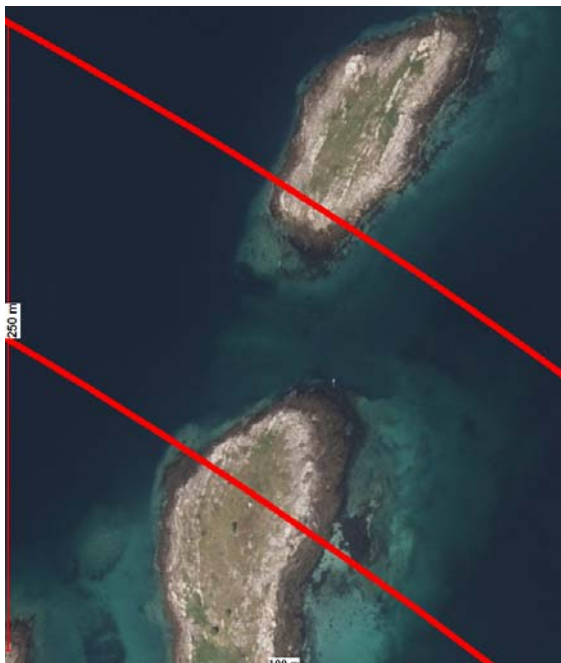
Figur 4: Utbedret farled betinger blant annet uttak av de to holmene mellom de røde linjene
